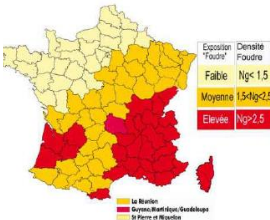
Figure 6-2 : Densité de foudroiement et niveau kéraunique
