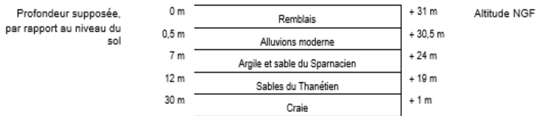
Figure 8-4 : Log schématique de la de la succession lithologique attendue au droit du site étudié
